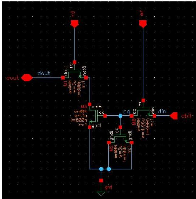
Fig. 6: DRAM 3T1D-Cell Architecture
