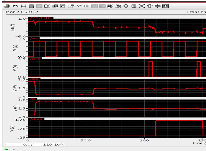
Fig. 7: Results of 6T SRAM For 0.6 um ami
