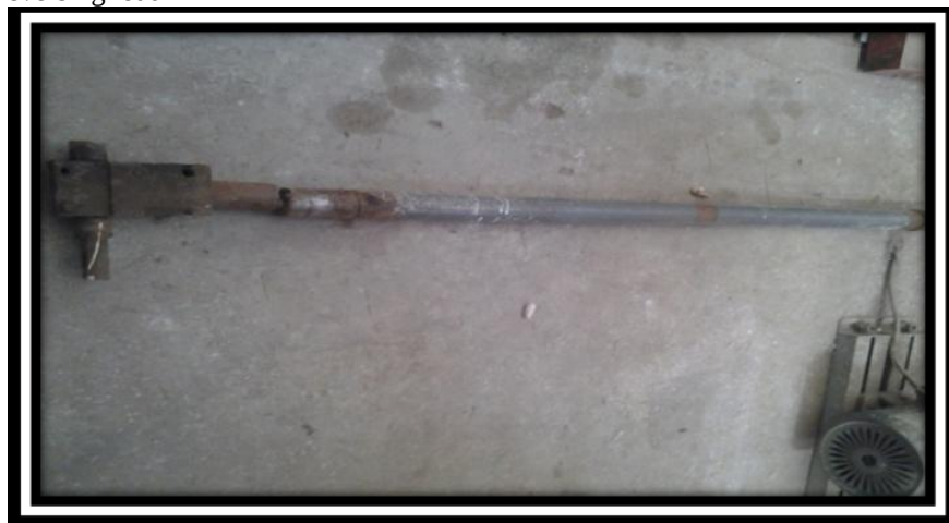
Fig. A. Broken Beater Shaft
