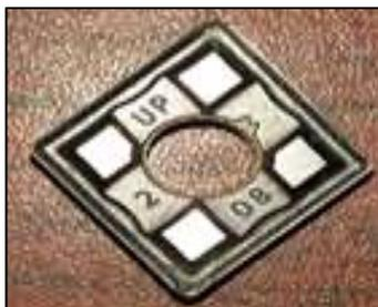
Fig. 3: Carbide Insert
