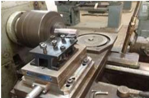
Fig. 5: Dynamometer
