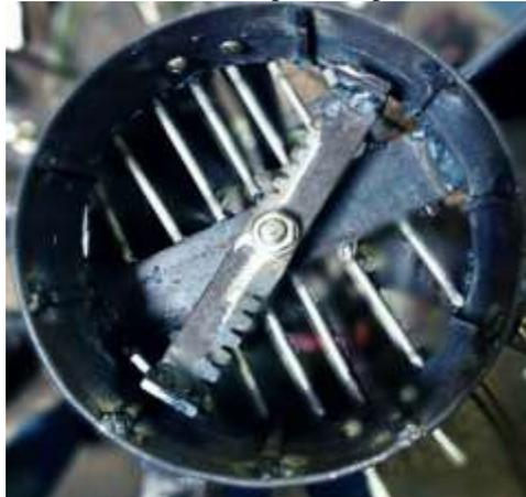
Fig. 3.1: Shredder Blades
